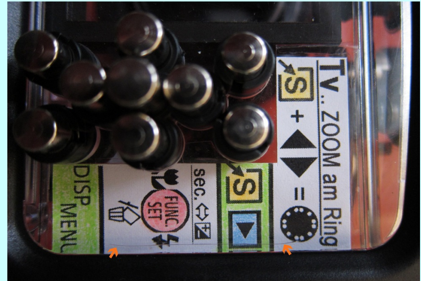
Bild 4: Einem Riss ähnlicher Spritzgussfehler an der Rückwand (Pfeile)
