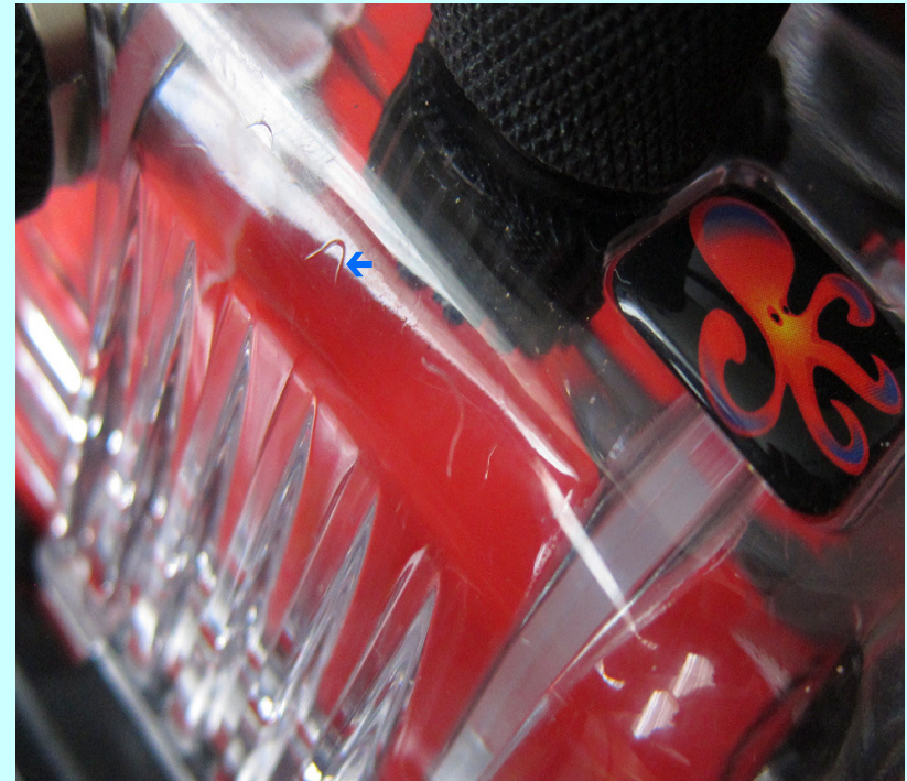
Bild 2: Spritzgussfehler an der Gehäuse-Vorderkante
