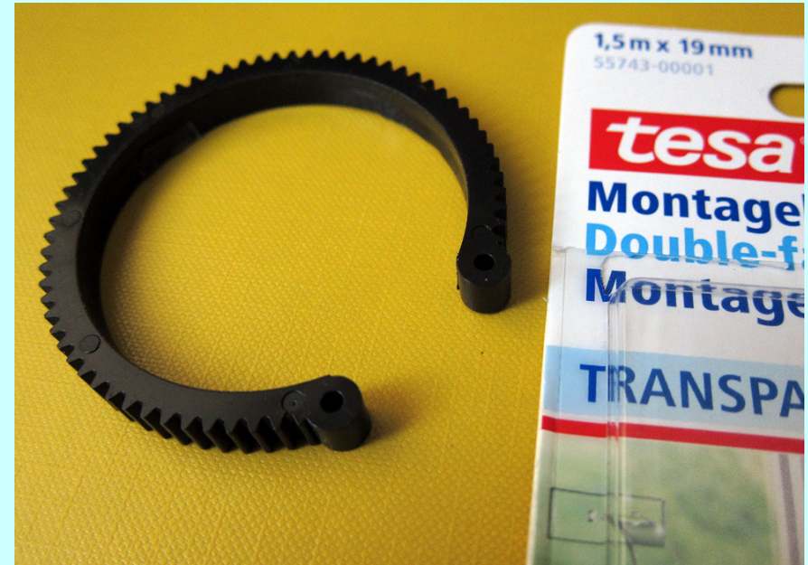
Bild 6: Zahnkranz und Montageband zur Absicherung seiner Funktion
