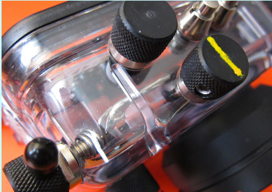
Bild 5: Markierung am Drehknopf beim Zoom-Hebel
